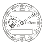
0-AUCUN AFFICHAGE DIGITAL (Position de référence de la couronne pour la sélection des fonctions)
